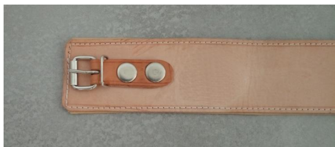
Ilustracja 4. Nitowanie paska z klamrą
