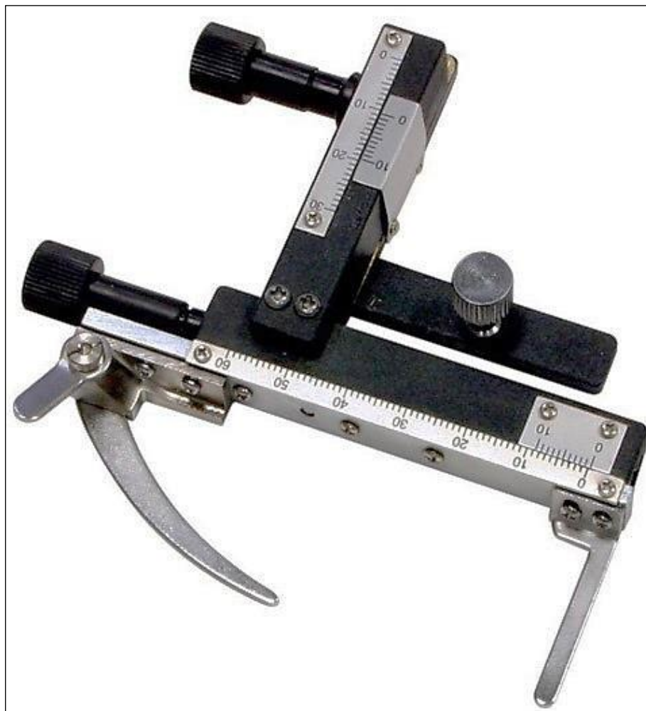
Rysunek 1. Nasadka krzyżowa do stolika mikroskopowego
