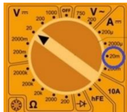
Rys. 2 Sposób zaznaczania ustawienia przełącznika multimetru. W przykładzie do pomiaru natężenia prądu w zakresie do 20 mA
